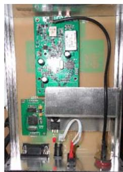
**泵房控制器：**安装在泵房里，由市电稳定供电。泵房控制器里的无线模块为中功率。传输距离在 2000 米左右。泵房控制器一直处于工作状态，主要任务是控制泵房里的设备，中继信号，唤醒和休眠条田控制器。[图 3]
